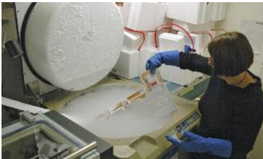
Figuur 4. Het bewaarvat met de damp van vloeibare stikstof. In het bewaarvat bevinden zich 14 canisters met daarin plaats voor 16 zakjes. Op de foto wordt een zakje getoond met een diepgevroren humane hartklep.
