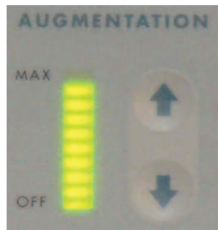
Afbeelding 2. Het afbouwen van de ballonvulling van de intra-aortale ballonpomp
