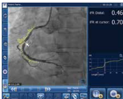
Afbeelding 3. SyncVision coregistratie, waarin de drukmetingen in de gehele coronair arterie zichtbaar gemaakt worden op het angiogram.
