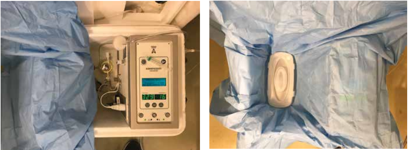
Figuur 2. De perfusiemachine om harten te bewaren op kamertemperatuur. Links de pompunit met kunstlong. Rechts het opgevouwen steriele veld met zicht op de deksel van het reservoir waar het hart in ligt tijdens de perfusie.
